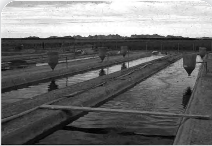
Şekil 1. İskandinav Ülkelerinde Alabalık yetiştiriciliğinde kullanılan kenarlarında belli aralıkla yerleştirilen sarkaç düzeneğine sahip silindirik mekanik yemliklerle desteklenen kanal tipi havuzlar.
